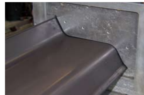
Выдавливание профиля Geoflex
